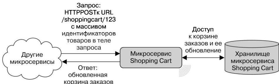
Рис. 2.6. Другие микросервисы могут добавлять товары в корзину заказов с помощью HTTP-запроса POST, содержащего в теле массив идентификаторов товаров
