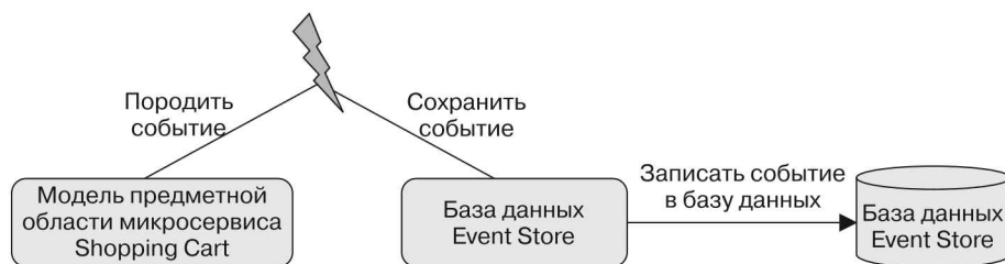
Рис. 5.8. При порождении моделью предметной области события код компонента EventStore должен записать его в базу данных Event Store
